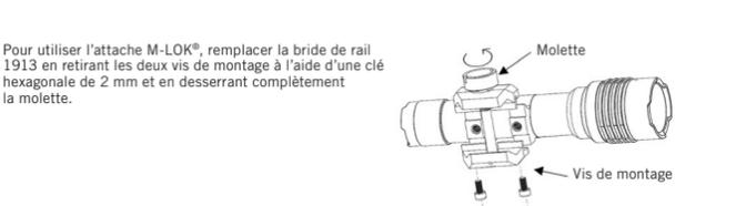
Aligner les orifices de montage M-LOK® avec les orifices de montage de la lampe montée sur rail ProTac® et utiliser la clé hexagonale 3/32 po pour serrer les 8 vis 32 x 1/4 po.
